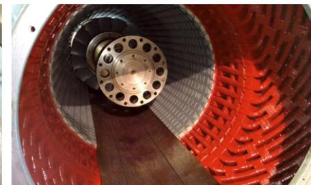
Interior del alternador después del ensayo
